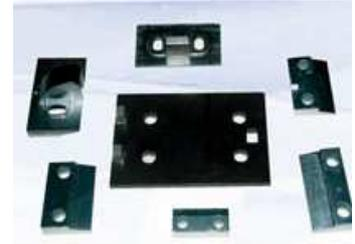
轨撑 止推座 止推垫板 压板
