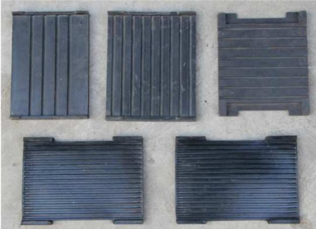
压作用下不会伸长，而是槽沟被压缩填满，增强了复合垫板的刚度，也可防止轨道在高轮压下产生过高的内应力，均布了起重机轮压，消除了集中载荷产生的疲劳应力。
