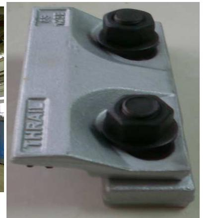
轮传来的侧向力。☆固定件能可靠地承受吊车运行中产生的侧向力。固定件窄而扁，可以提供最有利安装尺寸，可用于带或不带导向轮的各式吊车。通过楔形结构作用和互相啮合的压板上下两部两面倾斜而自动锁定。钢轨和吊车梁允差的控制不成问题，底座的预加应力和轨道与底座之间的持久接触都得到保证。有效降低噪音，改善工作环境。
